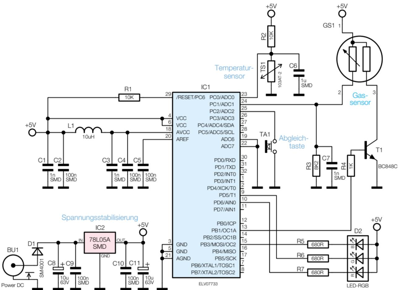
**Bild 3:** Die Schaltung des Luftgüte-Warners LG 300
