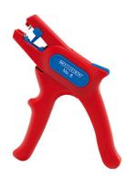
Die WEICON-Abisolierzange No. 6 verfügt über einen verstellbaren Längenanschlag von 5 – 12 mm. Dadurch werden alle flexiblen und massiven Leiter von 0,2 – 6,0 mm² (24 – 10 AWG) abisoliert. Der Längenanschlag kann bei Bedarf herausgenommen werden. Dieses vollisolierte Werkzeug unterliegt der Stückprüfung gemäß VDE-Vorschrift nach IEC 60900:2004, und hält einer Spannung von 1000 Volt stand.
