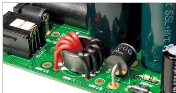
Bild 22: Auf die Leiterplatte montierte Entstördrossel L 400
