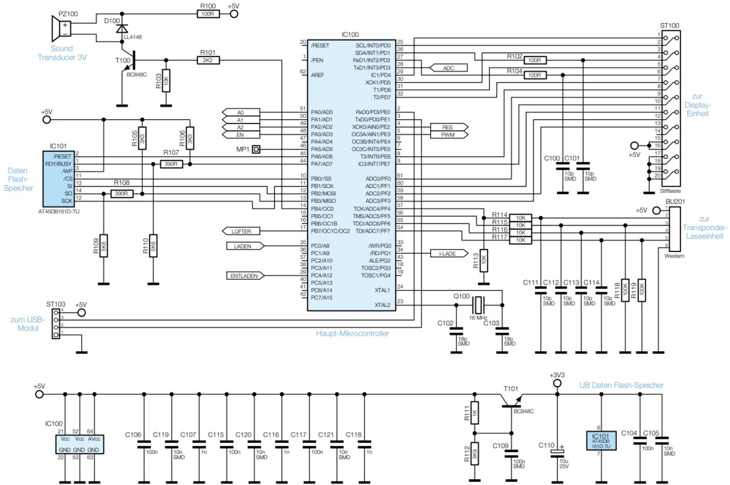
Bild 5: Das Mikrocontroller-Schaltbild des ALC 3000 PC
