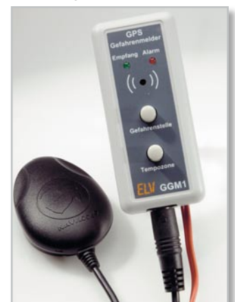
Bild 4: Der betriebsfertige GPS-Gefahrenmelder mit angeschlossenerm GPS-Empfänger
