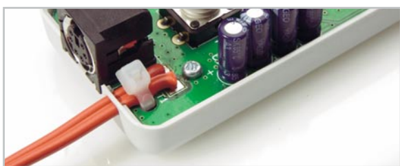
Bild 3: Anbringen der Anschlussleitung inkl. Zugentlastung
