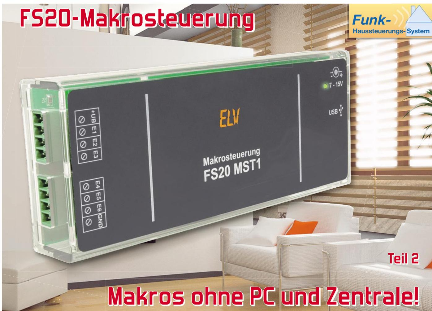
Makros sind eine prima Sache, wenn es im Haussteuerungs-System darum geht, mit einem Befehl komplexere Abläufe zu starten. Allerdings ist im FS20-System bisher dazu entweder ein ständig laufender PC und/oder eine Funk-Hauszentrale erforderlich. Die neue Makrosteuerung hingegen arbeitet nach der Konfiguration autark und kann bis zu 50 Makros mit variabler Aktionsanzahl verwalten und auslösen. Im zweiten Teil beschäftigen wir uns mit der Schaltungstechnik und dem Aufbau der Steuerung.
