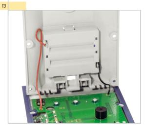
An den Minuskontakt der unteren Batterie wird die schwarze von ST 2 kommende Leitung und an den Pluskontakt der oberen Batterie die rote von ST 1 der Basisplatine kommende Leitung angelötet.
