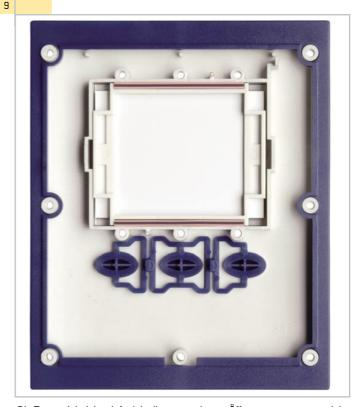
Die Tasteneinheit ist einfach in die vorgesehenen Öffnungen zu setzen und der blaue Designrahmen ist wie abgebildet über die sieben Schraubdome der Gehäusefront zu legen.
