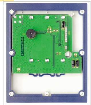
Im nächsten Arbeitsschritt wird die Basisplatine, wie in der Abbildung zu sehen, über dem Display positioniert und mit sechs Schrauben für Kunststoff 3 x 6 mm fest verschraubt.
