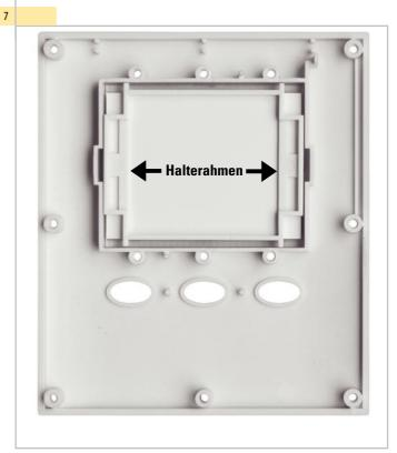
Der Halterahmen wird, wie in der Abbildung zu sehen, auf die Rückseite des Displays gelegt.
