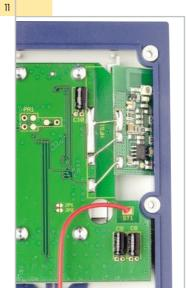
Das HF-Empfangsmodul ist wie abgebildet in den Gehäuseschlitz des Gehäusefrontteils zu legen. Danach sind die bereits vorbestückten Anschlussleitungen entsprechend der Abbildung abzuwinkeln, auf die erforderliche Länge zu kürzen und sorgfältig an die zugehörigen Platinenanschlüsse anzulöten.
