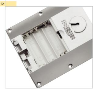
In die zugehörigen Führungsschienen der Gehäuserückseite sind zwei Batterie-Doppelkontakte und zwei Batterie-Einzelkontakte einzurasten.
