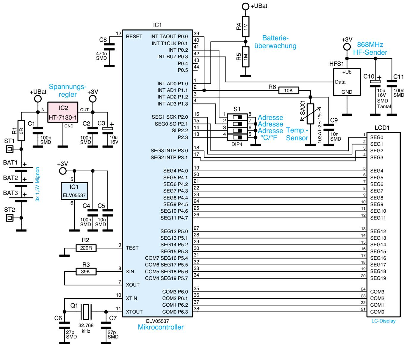
Bild 2: Schaltung des Pool-Sensors PS 50
