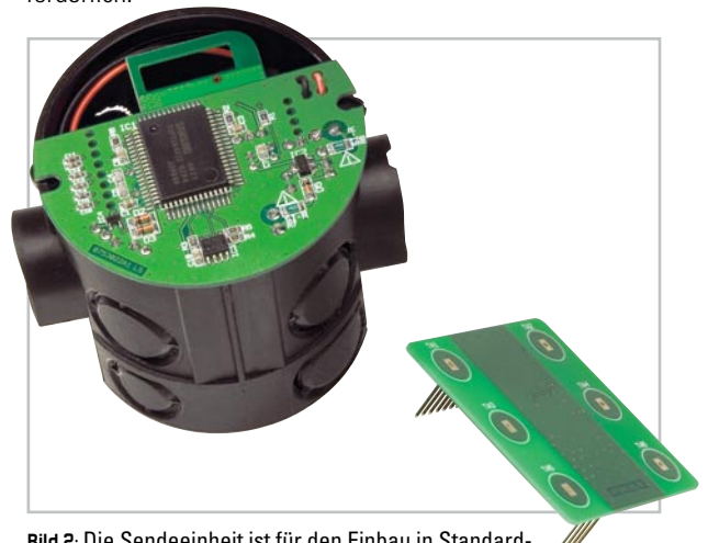
Bild 2: Die Sendeeinheit ist für den Einbau in Standard-UP-Dosen vorgesehen.
