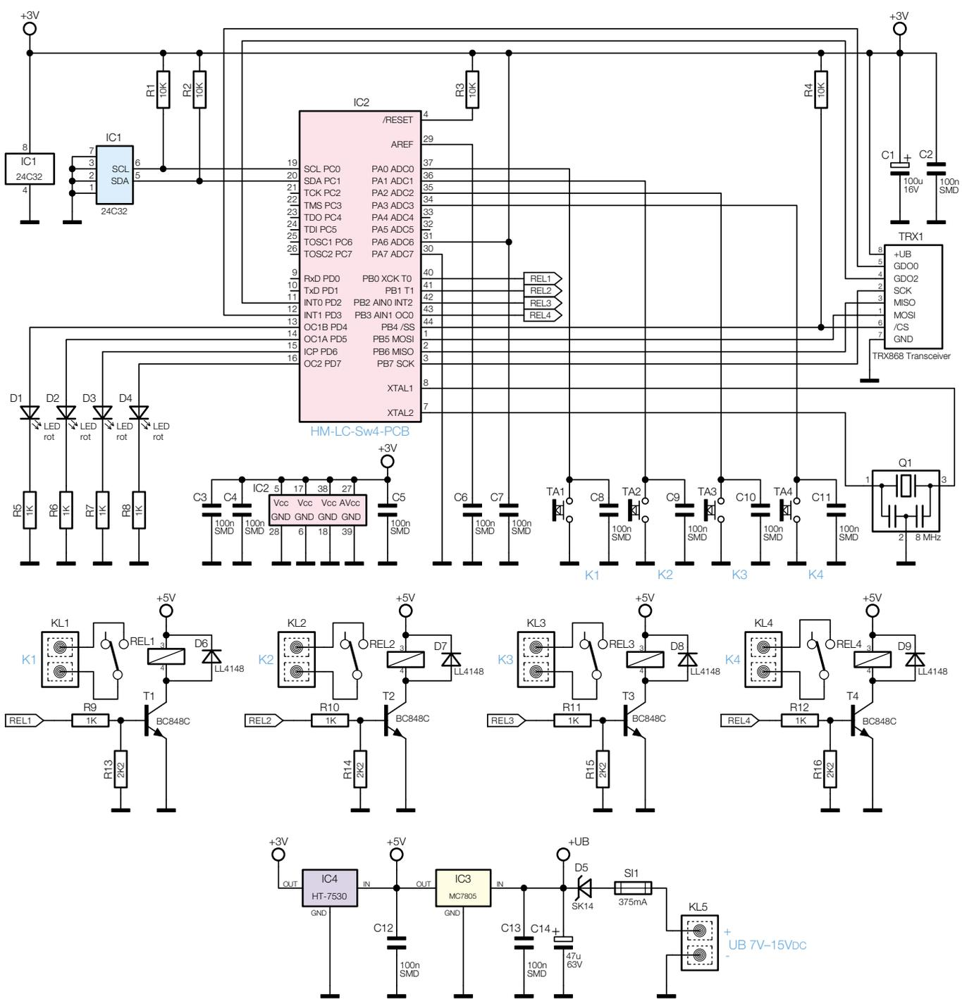
Bild 3: Das Schaltbild des 4-Kanal-Empfängers
