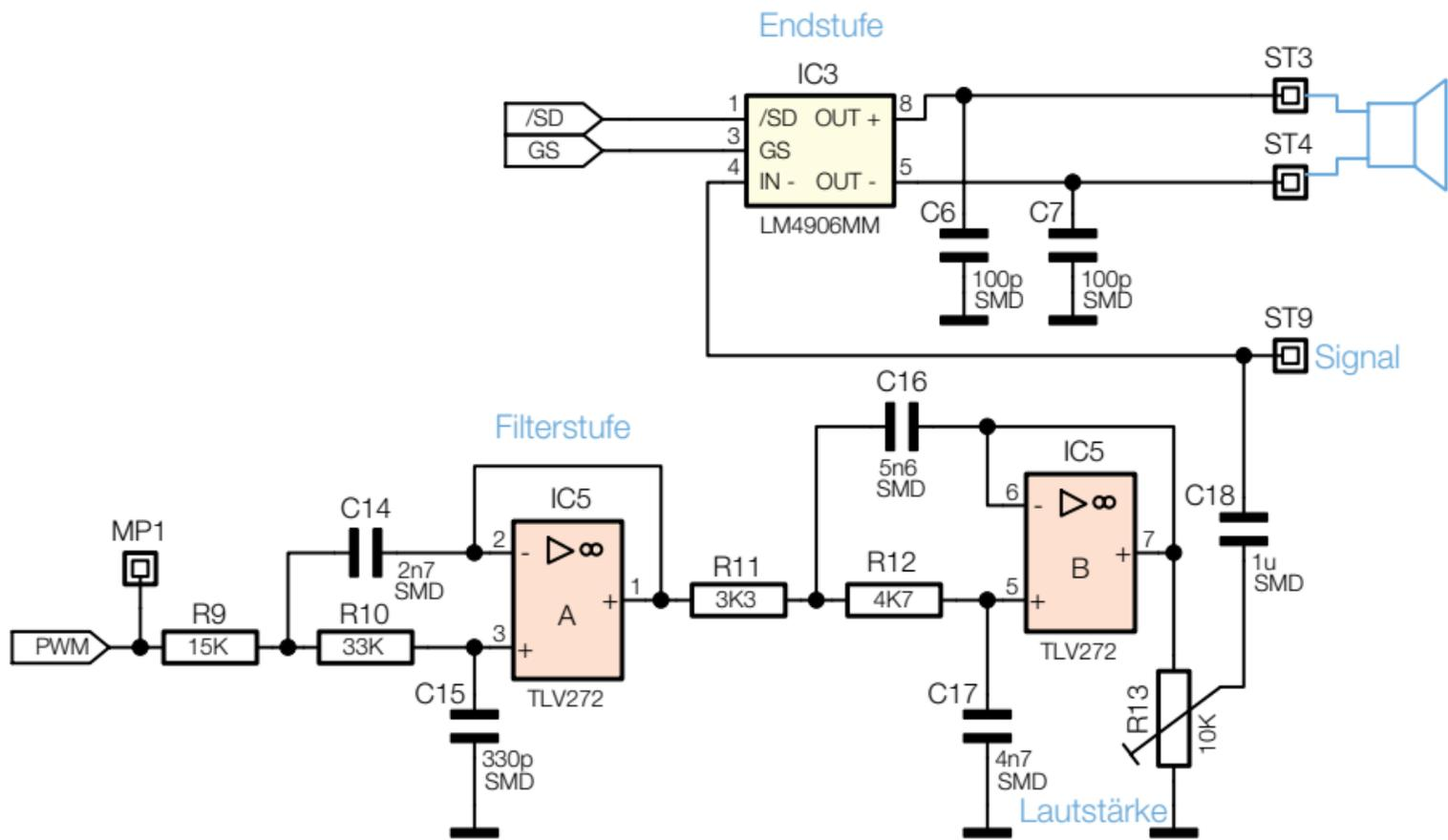
**Bild 4: Das Schaltbild des Analogteils**
