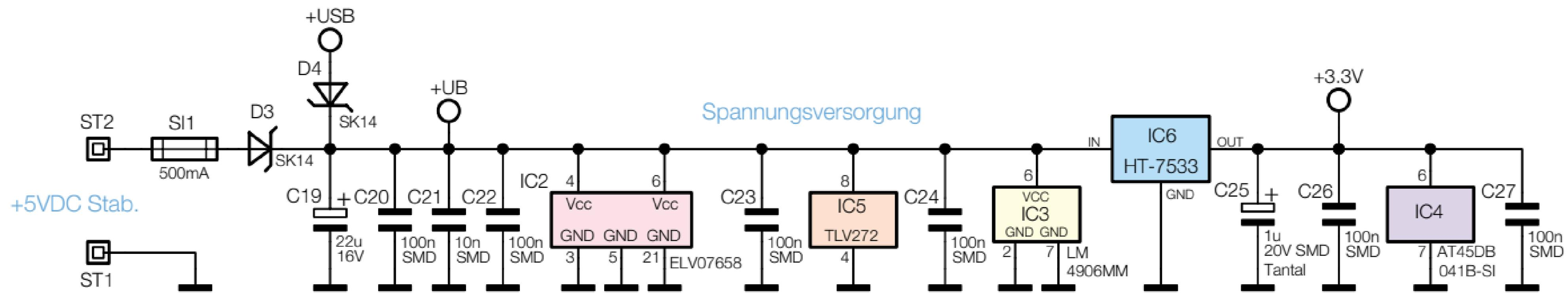
**Bild 2: Das Schaltbild der Spannungsversorgung**
