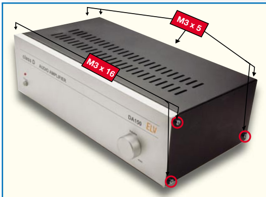
Bild 16: Montage des Gehäusedeckels mit Inbusschrauben
