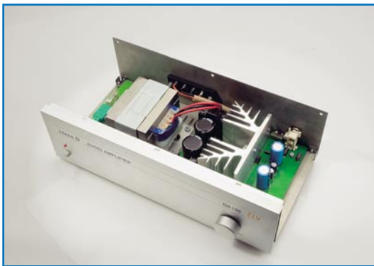
Bild 15: Innenansicht des fertig aufgebauten Class-D-Verstärkers
