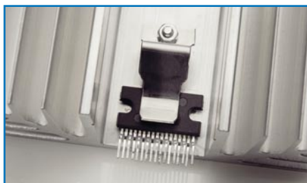
Bild 9: Montage des Endstufen-ICs TDA 8927 am Kühlkörper
