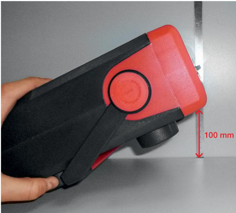
Bild 4: Auch ein Fallhöhentest gehört zum Prüfprogramm.
