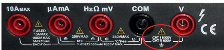
Bild 2: Sicherheitsklasse und Herstellerdeklaration sind gekennzeichnet.
