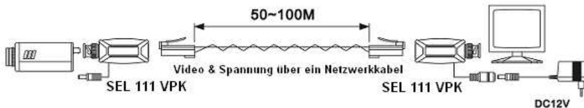
Schließen Sie einen SEL 111 VPK an die Videosignalquelle, z.B. eine Kamera, über die BNC Verbindung an und führen die Spannungsversorgung über den Hohlstecker zu.
