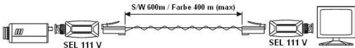
Schließen Sie einen SEL 111 V an die Videosignalquelle z.B. eine Kamera an. Der zweite SEL 111 V wird mit dem Wiedergabegerät z.B. Monitor oder Aufzeichnungsgerät verbunden. Die Übertragung erfolgt mit einem 1:1 Netzkabel, welches über die RJ 45 Buchsen des Senders und Empfängers anzuschließen ist. Es wird empfohlen die Übertragungsleitung nicht neben Spannungsführenden Leitungen zu verlegen, da dies zu Störungen führen kann.
