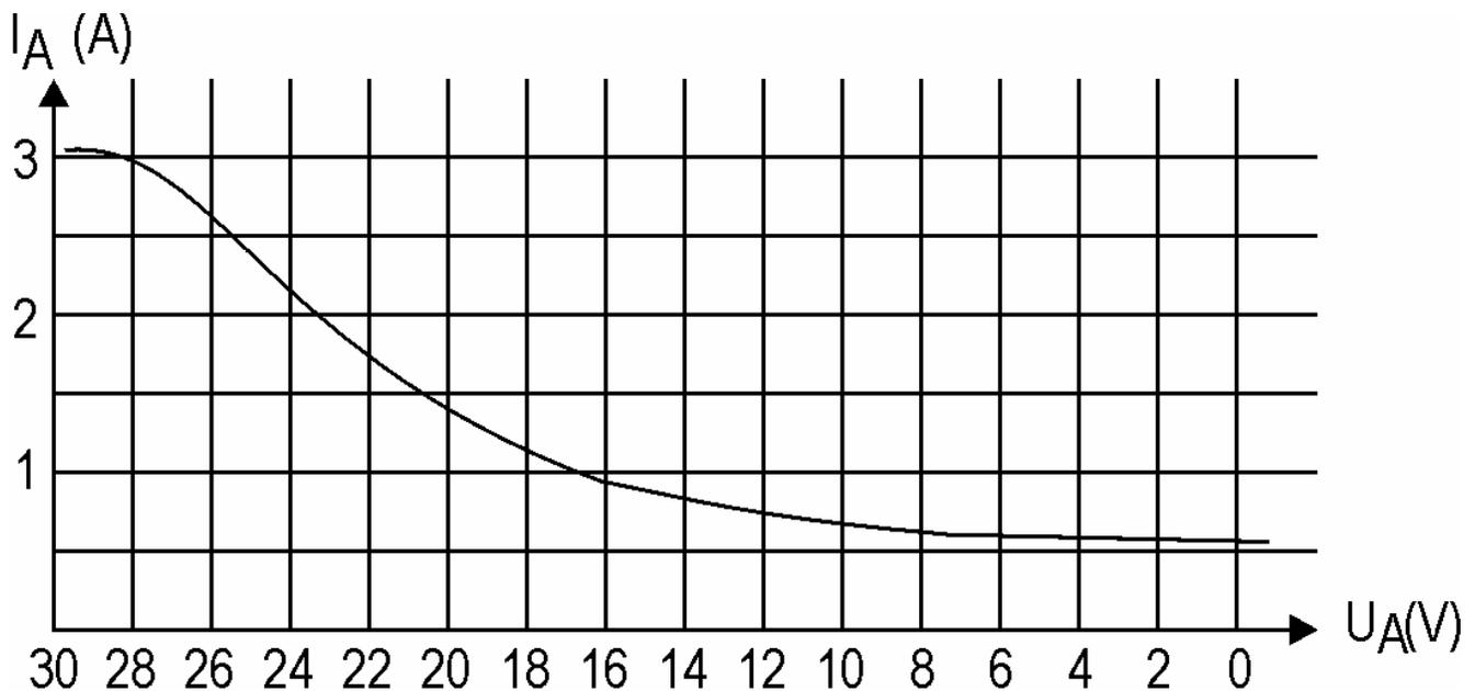
Maximal entnehmbarer Strom in Abhängigkeit von der eingestellten Ausgangsspannung. Angaben beziehen sich auf eine Eingang-Wechselspannung von 25 V, Verlustleistung max. 20 W.
