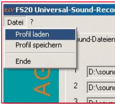
Bild 4: Über „Profil laden/speichern“ ist die Speicherung der gesamten Gerätekonfiguration auf dem PC ebenso möglich wie das blitzschnelle Laden einer kompletten Konfiguration aus dem PC in den Sound-Recorder
