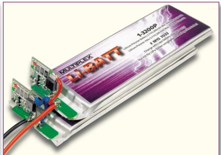
**Bild 5: 2-zelliger Lithium-Polymer-Akku mit nachgerüsteten Balancern**
