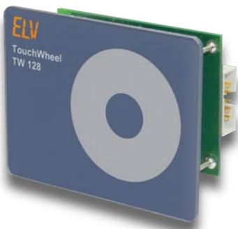
Bild 9: Frontplatte und Platine müssen wie gezeigt so montiert werden, dass sich Bedienfeld und Wannenstecker auf der rechten Seite befinden.
