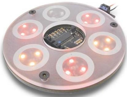
**Bild 3:** Berührungssensoren sind hervorragend für die Hinterleuchtung geeignet (Foto: Quantum)
