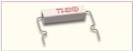
**Bild 7: So müssen die Anschlüsse bei den Hochlastwiderständen abgewinkelt werden**
