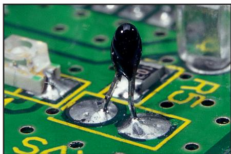
**Bild 5: Sensor zur Temperaturmessung**
