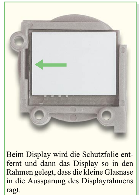
Montage des Displays im Displayrahmen
