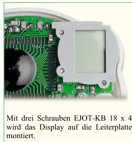
Montage der Displayeinheit auf der Leiterplatte
