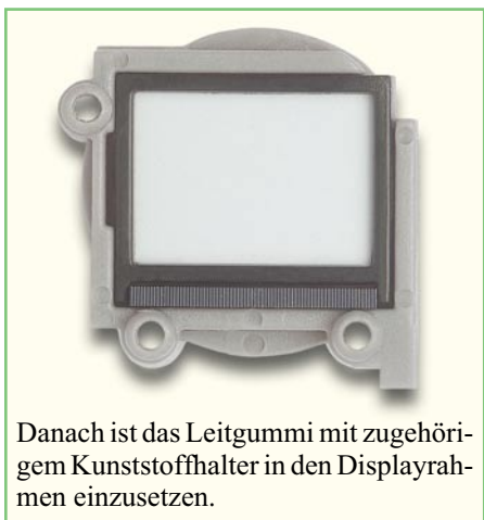
Einsetzen des Leitgummistreifens mit Halterahmen
