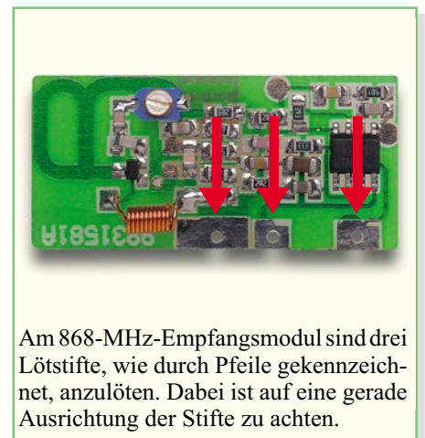
Das Empfangsmodul wird zuerst mit 3 Lötstiften bestückt.
