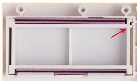
**Bild 17: Montage der Leitgummistreifen mit Halterahmen**
