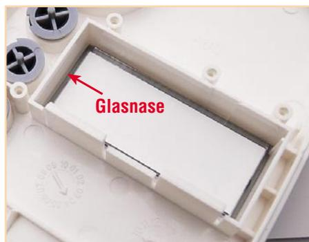
**Bild 16: Polaritätsrichtiges Einsetzen des Displays**
