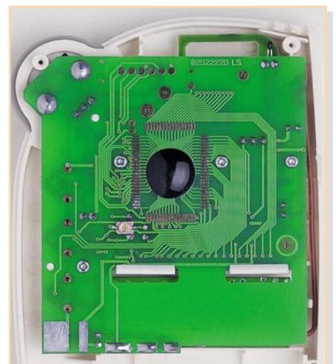
**Bild 18: Endmontage der Elektronik in das Gehäuse**
