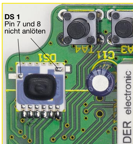
Bild 5: Detailansicht zur Montage des Luftdrucksensors
