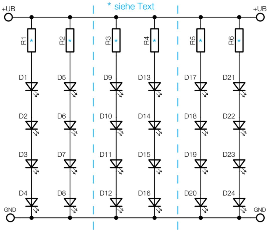
**Bild 1: Schaltbild des LED-Streifenmoduls**
