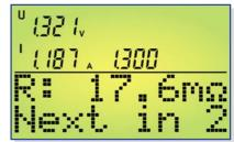
Bild 23: Hauptfenster der Ri-Messfunktion
