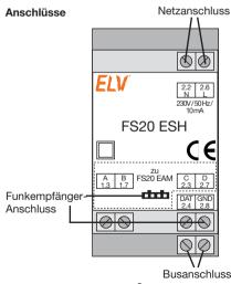
Setzen Sie das Netzteil auf die Hutschiene auf und verriegeln Sie es mit der Schiene. Achten Sie dabei darauf, dass die Rastfeder komplett einrastet und das Gerät fest auf der Schiene sitzt.
