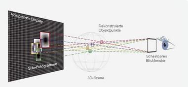
Bild 14: Durch Eye-Tracking kann das Display erkennen, welchen Objektbereich der Zuschauer betrachtet, und ihm nur die dafür notwendigen Informationen aus kleineren Sub-Hologrammen schicken. (Quelle: SeeReal)
