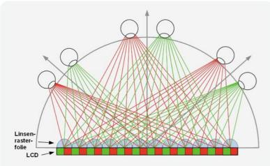
Bild 12: Nur aus bestimmten, halbkreisförmig um die Linsenrasterfolie angeordneten Zonen ist das stereoskopische Bild klar sichtbar.
