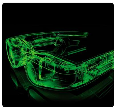
Bild 9: Das Röntgenbild einer Cinemizerplus-3D-Videobrille (Quelle: Zeiss)
