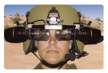
Bild 11: SimEye SX100 mit SXGA-Auflösung, 1280 x 1024 Pixel: vielleicht der Traum eines Power-Gamers, aber sicher der Albtraum eines durchschnittlichen 3D-TV-Zuschauers (Quelle: Rockwell Collins)
