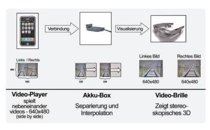
Bild 10: Die Cinemizerplus wird mit einem "Side-by-Side"-Videostream gespeist und erzeugt daraus Videostreams für das linke und das rechte Auge. (Quelle: Zeiss)
