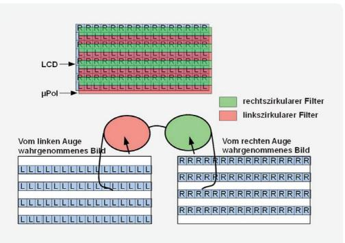
Bild 7: Ein Mikro-Polarisationsfilter polarisiert die Zeilen eines Bildes abwechselnd gegensätzlich. So können mit einer geeigneten Brille die geradzahligen Zeilen auf das eine und die ungeradzahligen Zeilen auf das andere Auge geleitet werden.
