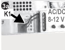
**Spannungsversorgung mit  $\approx$ 8-12V (0,5A)**
