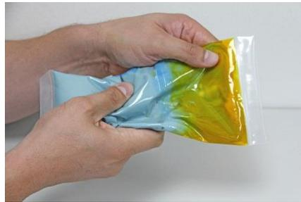
7. Mischen des Zwei-Komponenten-Gießharz durch gutes Durchkneten (ca. 3 Minuten) des geschlossenen Beutels.
