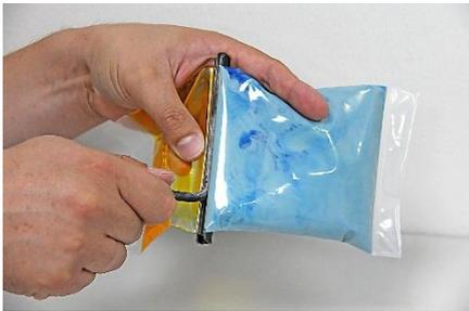
6. Vorbereiten des ISO FLEX Gießharz durch Herausziehen der Feuchtigkeitssperre, die den Beutel in zwei Kammern unterteilt.
