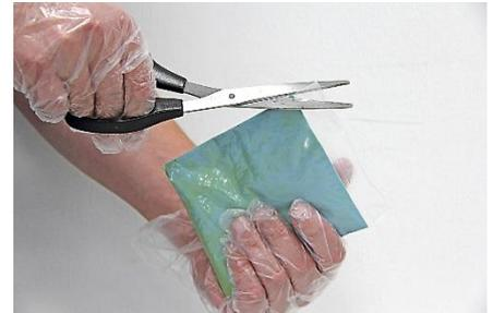
8. Handschuhe anziehen und den Beutel mit dem vorbereiteten Gießharz aufschneiden.
