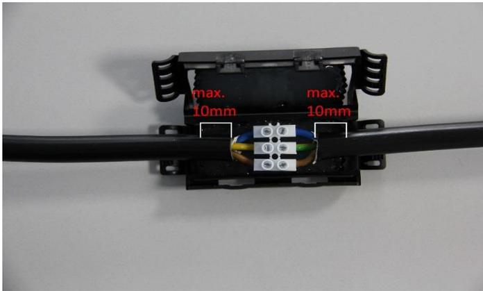
**5.** Die Kabelverbindung mittig in die offene ISO FLEX Gelmuffe Größe S legen. Auf beiden Seiten der Kabelverbindung muss ein Stück des Kabels mit Außenummantelung (ca. 10mm) bis in die Gelmuffe ragen, um eine sichere wasserdichte Kabelverbindung herzustellen.
