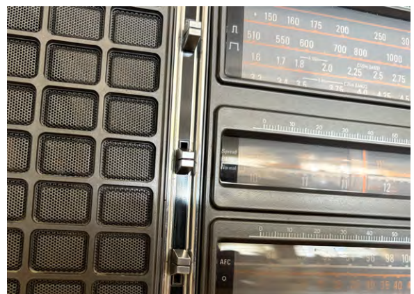
Bild 8: Die Wahlschalter sind oft abgebrochen oder fehlen.
