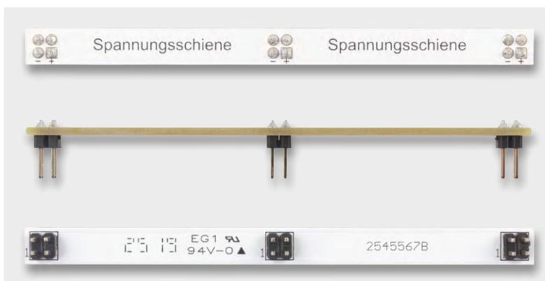
Bild 3: Ansichten der Brückenplatte
