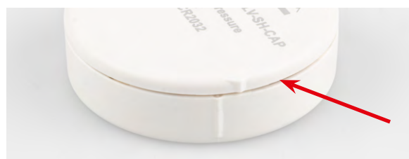
Bild 16: Ausrichten der Platine gemäß der Markierung
