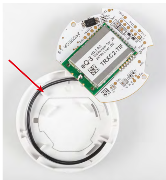
Bild 15: So wird die Antenne in das Gehäuseunterteil geklemmt.
