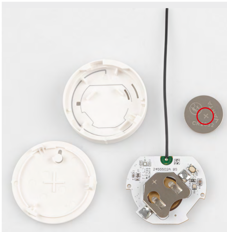
Bild 2: Bausatz aus nur vier Teilen – ganz ohne Löten
