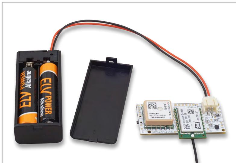
Bild 2: Batteriefach in Kombination mit dem ELV-LW-GPS2
