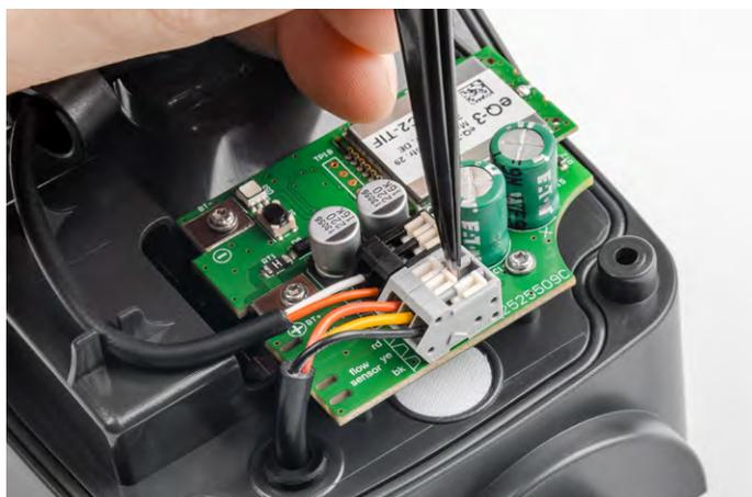
Bild 11: Klemmen öffnen, Kabel einführen und Klemmen schließen
