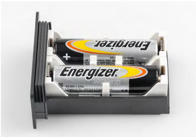
Bild 18: Fertiges Batteriefach mit eingelegten Batterien
