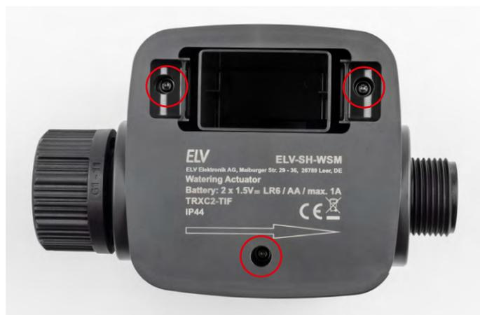
Bild 14: Unterseite verschrauben
