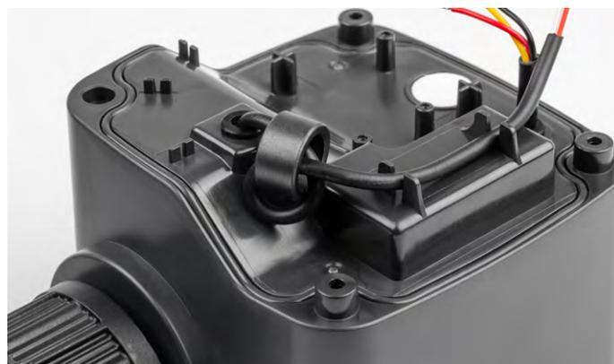
Bild 9: Ferritring mit Kabelschlaufe
