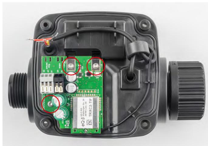
Bild 10: Platine mit 3 Schrauben fixieren
