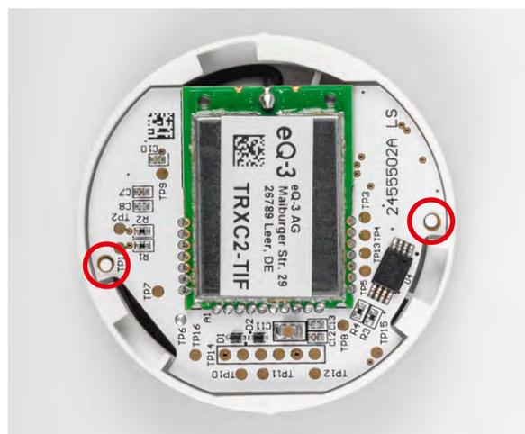
Bild 16: Ausrichten der Platine gemäß der Markierung
