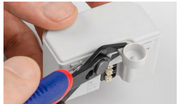
Bild 4: Fixieröse bei einem Aktor entfernen
