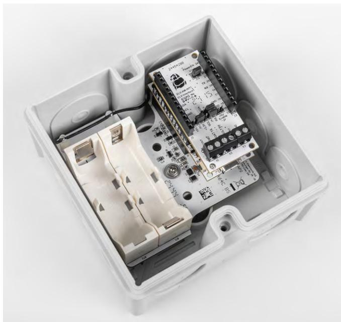
Bild 14: Fertiger Modulstapel mit fixierter Antenne
