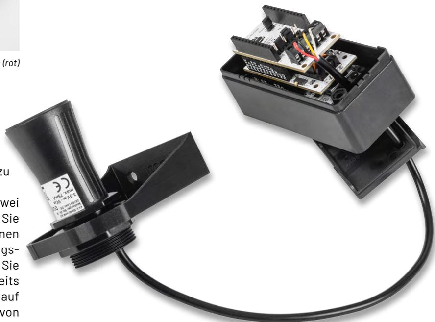
Bild 10: Modulstapel mit ins Gehäuse geführtem Sensorkabel
