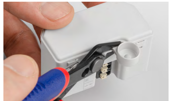
Bild 4: Fixieröse bei einem Aktor entfernen
