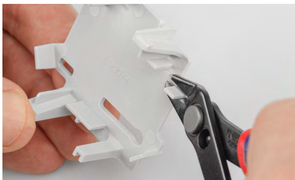
Bild 5: Bei Verwendung des HmlP-FSI16 den Steg an der Halteplatte entfernen
