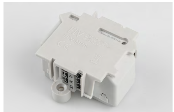
Bild 6: Halteplatte auf den Aktor aufsetzen
