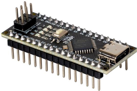
Der NanoV4-MC ist ein besonders kleiner Mikrocontroller und durch die nach unten herausgeführte Stiftleiste, speziell für die Arbeit mit Steckboards entwickelt.
