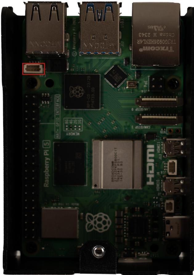
Wenn Sie den Lüfter nicht verwenden wollen, können Sie diesen durch das Lösen der zwei unten markierten Schrauben entfernen:
