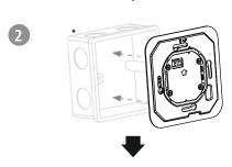
Schrauben Sie die Elektronik mit dem beiliegenden Montagematerial fest. Achten Sie dabei auf die korrekte Ausrichtung.
