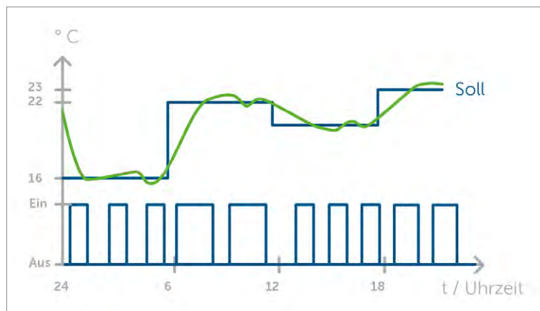
Bild 3: PWM-Regelung in der Heizungstechnik (Puls-Pausen-Verhältnisse nur exemplarisch)
