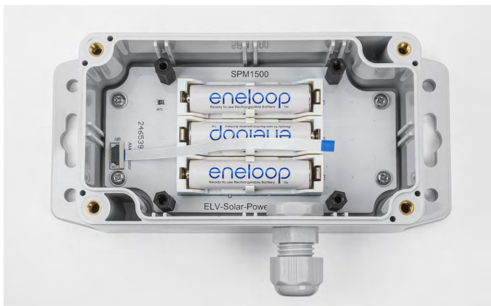
Bild 16: Gehäuseunterteil mit Kabelverschraubung auf der langen Gehäusesseite und montierter SPM1500-Akku-Platine
