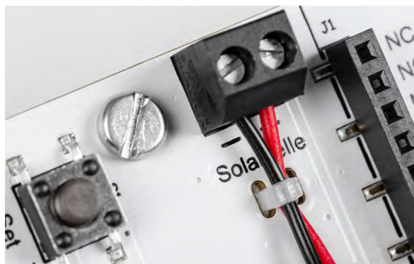
Bild 20: Sicherung der Anschlussleitungen an Klemme X2 mit einem Kabelbinder
