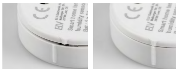
Bild 18: Schließen des Gehäuses durch Verdrehen
