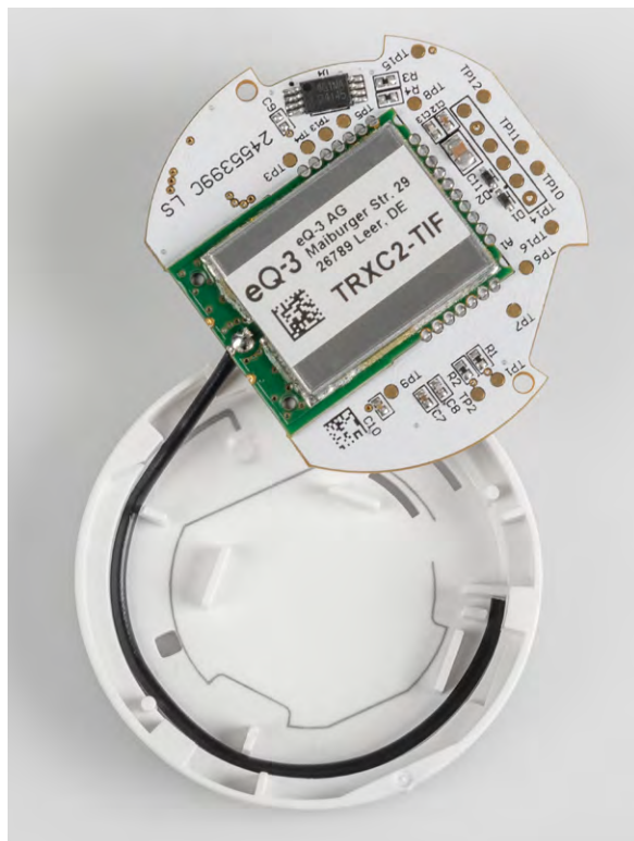
Bild 16: So wird die Antenne in das Batteriefach geklemmt.
