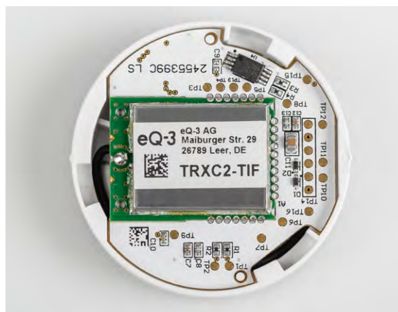
Bild 17: Ausrichten der Platine gemäß der Markierung
