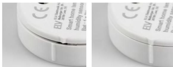
Bild 18: Schließen des Gehäuses durch Verdrehen
