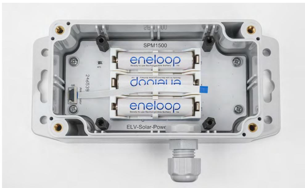
Bild 16: Gehäuseunterteil mit Kabelverschraubung auf der langen Gehäusesseite und montierter SPM1500-Akku-Platine
