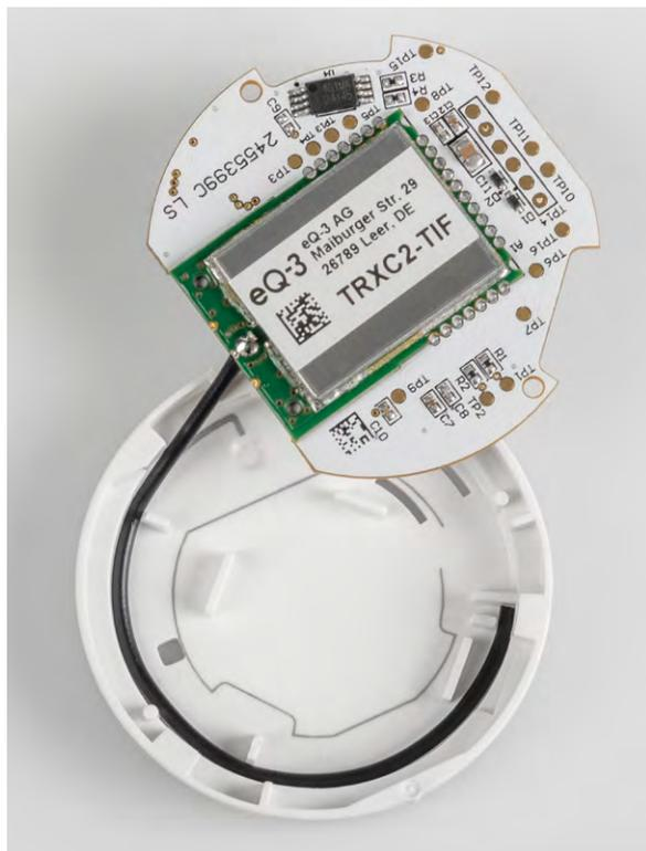
Bild 16: So wird die Antenne in das Batteriefach geklemmt.
