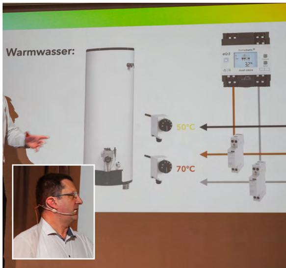
Bild 4: Erläuterung des elektrischen Aufheizens eines Warmwasserspeichers
