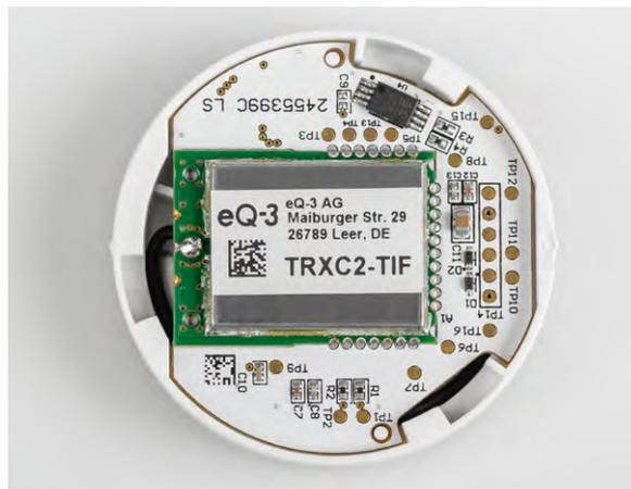
Bild 17: Ausrichten der Platine gemäß der Markierung
