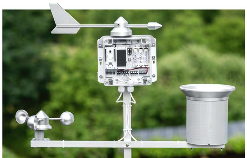
Bild 2: Die ELV Wetterstation mit dem Wetterboard ELV-EM-WB
