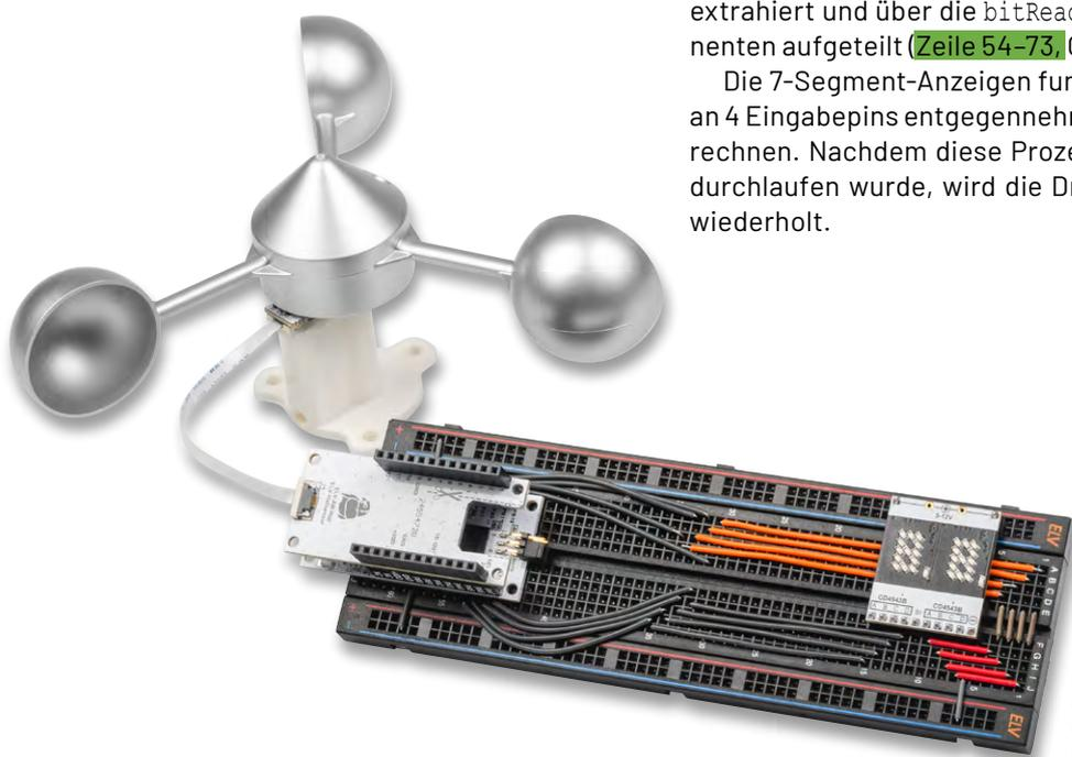
Bild 10: Gesamtaufbau des Drehzahlmessers. Unterhalb des Anemometers befindet sich ein Magnet, der den Magnetsensor des ELV Applikationsmoduls Hallsensor auslöst.
