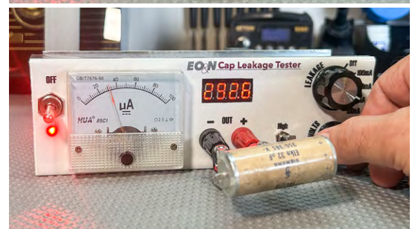
Bild 2: Leckströme können bei erhöhter Spannung unterhalb der maximalen Nennspannung des Bauteils gemessen werden.
