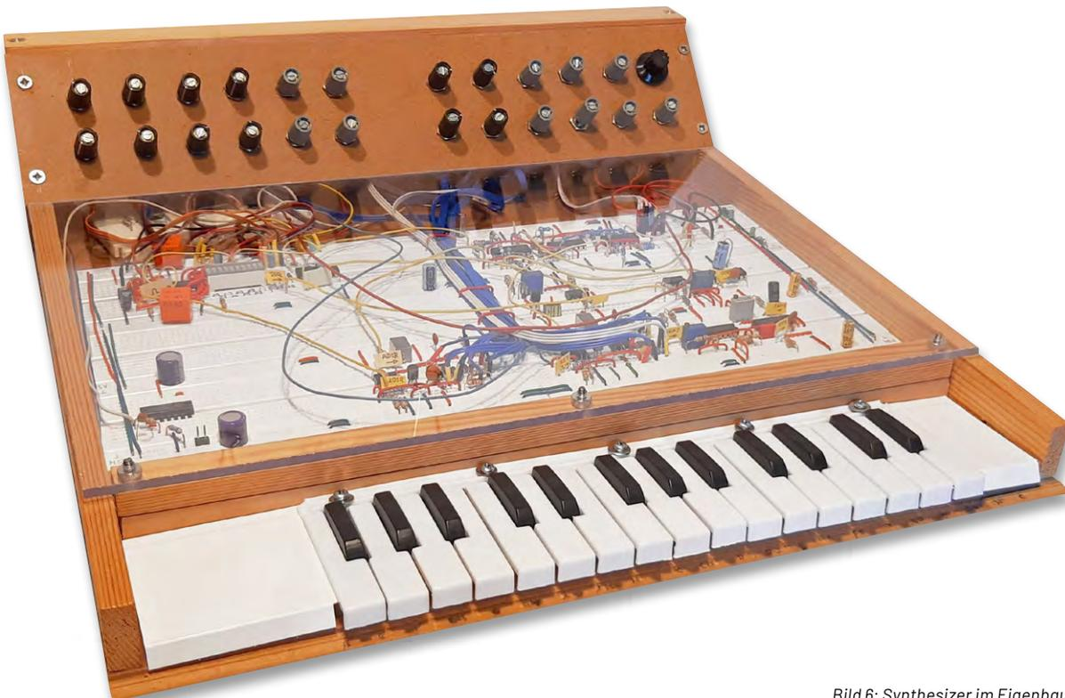
Bild 6: Synthesizer im Eigenbau
