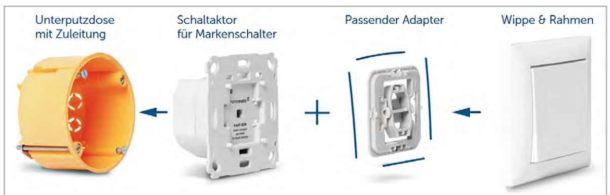
Bild 2: Einbau eines Aktors im Markenformat inkl. vorhandener Wippe
